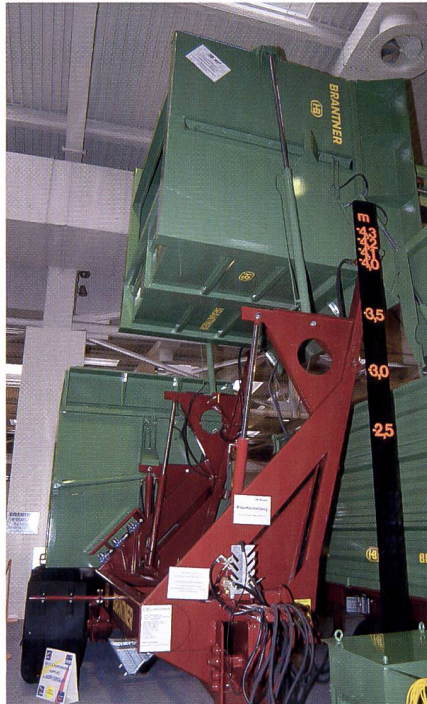
Bei neuen Maschinen setzen die Strassenverkehrsvorgaben mehr und mehr nicht nur Grenzen bei Breite und Länge, sondern auch in der Höhe: Immer mehr Fahrzeuge erreichen die erlaubten 4 Meter.
