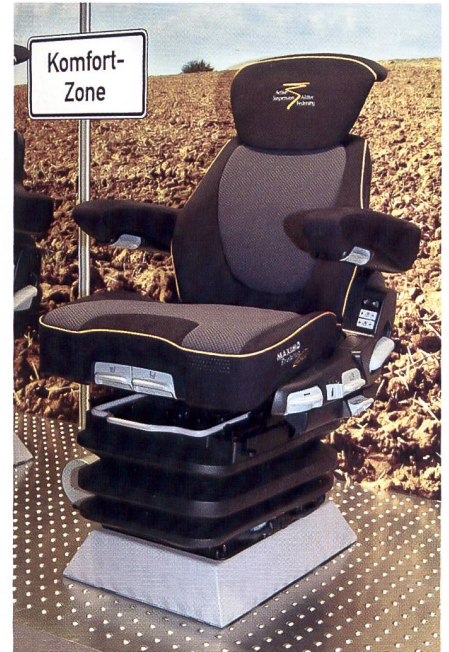
Grammer bietet den vor zwei Jahren vorgestellten Sitz mit aktiver Federung nun auch für die Nachrüstung an. Er findet jedoch nur auf grösseren Traktoren genügend Platz.
