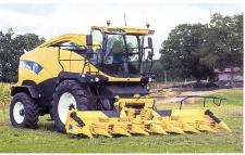
tem kann von einer Person ohne Werkzeuge in weniger als zwei Minuten umgeschaltet werden. Dank diesem System brauchen beim abwechselnden Häckseln von Gras, Mais und Ganzpflanzen keine grösseren Änderungen an der Einstellung vorgenommen zu werden. Die New-Holland-Power-Cruise™- und Turbo-Compound-Technik der FR9000-Feldhäcksler gewährleistet eine hohe Leistung bei niedrigem Kraftstoffverbrauch.
