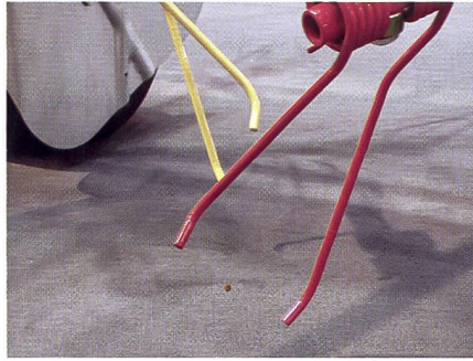
Dem abgewinkelten Federzinken von Lely wird nachgesagt, dass er das Futter besonders sauber vom Boden aufnimmt.
