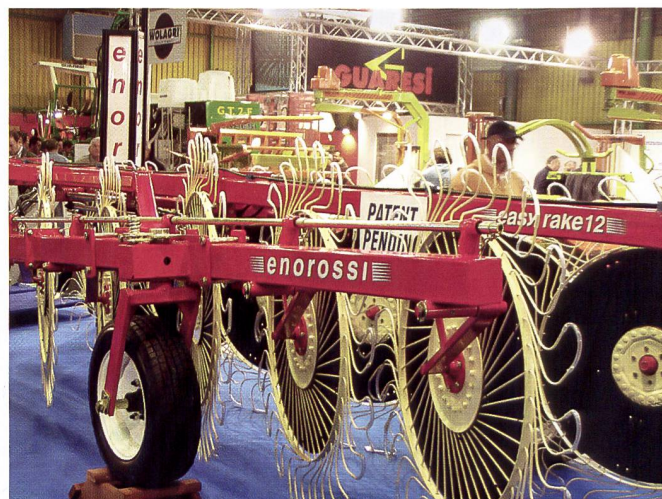
Sternradrechen ermöglichen Fahrgeschwindigkeiten bis 20 km/h und erreichen somit eine enorme Flächenleistung.
