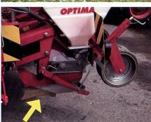
Abb. 7: Scheibenscharen (oben) besitzen den Hauptvorteil, dass sie im Vergleich zu Meisselscharen (unten) nicht verstopfen. Wird jedoch zu hoher Anpressdruck auf die Scheiben angewendet, kann sich der Säschlitz stark verdichten. Vorteil der Meisselschar ist, dass sie den Schlitz aufreisst und ihn nicht mit hohem Gewicht wieder zupresst.
