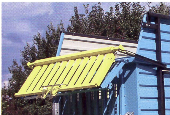
Mengele «Abklappen der Stirnwand»
