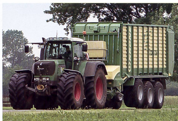
Krone «Tridemachse auf vier Rädern für Strassenfahrt»
