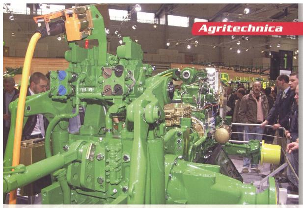
John Deere 7430 und 753 E-Premium können neuerdings mit einem System zur Erzeugung und Verteilung von elektrischer Energie ausgerüstet werden.
