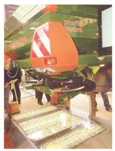
Argus-Kamera auf Amazone-Zweikreisel-Düngerstreuer: Über eine gepulste Infrarot-Strahlung wird die Verteilung der Düngerkörner permanent überprüft und an die im Bordcomputer gespeicherten Sollwerte angepasst.
