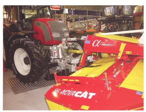
Der lenkbare Frontkraftheber folgt bis zu 35° automatisch dem Radeinschlag der Vorderräder. Dadurch kann der Überschnitt von Mähwerken in Front-Heckkombinationen deutlich reduziert werden.
