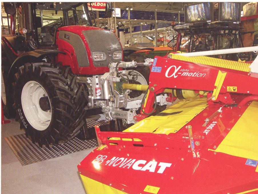
Der lenkbare Frontkraftheber folgt bis zu 35° automatisch dem Radeinschlag der Vorderräder. Dadurch kann der Überschnitt von Mähwerken in Front-Heckkombinationen deutlich reduziert werden.
