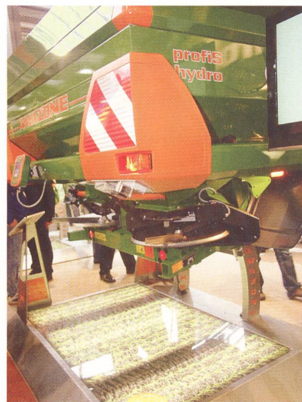
Argus-Kamera auf Amazone-Zweikreiseldüngerstreuer: Über eine gepulste Infrarot-Strahlung wird die Verteilung der Düngerkörner permanent überprüft und an die im Bordcomputer gespeicherten Sollwerte angepasst.
