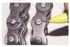
Diese Zweifachkette aus einem Anbauhäcksler ist stark beschädigt, zurückzuführen auf ungleiche Fluchten der beiden Kettenräder.
