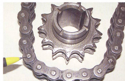
Scharfe Zahnschmelzen an Kettenrädern weisen auf grossen Verschleiss hin. Kette und Kettenrad müssen gleichzeitig ersetzt werden.
