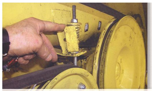
Diese Einstellhilfe gibt vor, auf welche Länge die Feder dieser Riemenspannvorrichtung einzustellen ist. Sie wird da angebracht, wo der Riementrieb zugleich als Überlastkupplung funktioniert.
