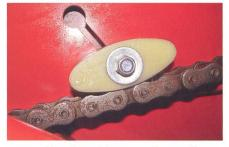
Diese Kettenführung aus Kunststoff verhindert das Schlingern des unbelasteten Kettenteils, der als Leertrum bezeichnet wird.
