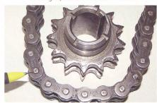
Scharfe Zahnspitzen an Kettenrädern weisen auf grossen Verschleiss hin. Kette und Kettenrad müssen gleichzeitig ersetzt werden.
