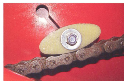
Diese Kettenführung aus Kunststoff verhindert das Schlingern des unbelasteten Kettenteils, der als Leertrum bezeichnet wird.
