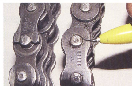
Diese Doppelkette aus einem Anbauhäcksler ist stark beschädigt, zurückzuführen auf ungleiche Fluchten der beiden Kettenräder.
