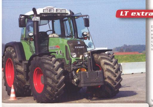
Ein 820 Vario fährt sich selbst exakt auf der vorgängig aufgezeichneten Kurvenstrecke: Bei Fendt heisst das automatische Spurführungssystem via Satellitenpeilung und Korrektursignal Auto Guide.
