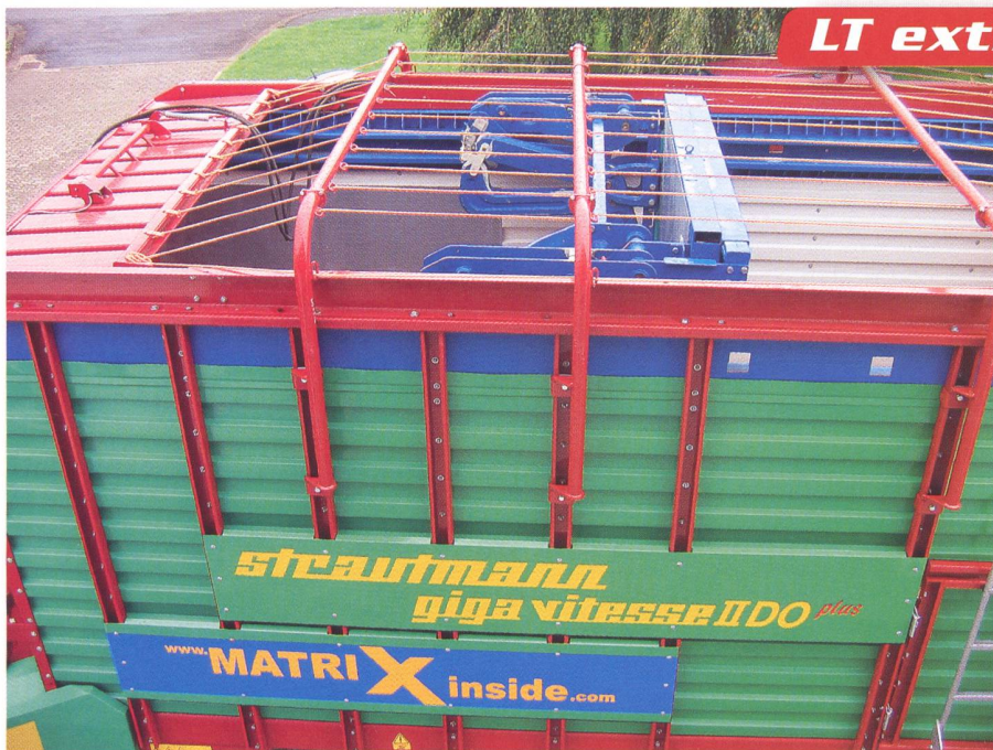
Strautmann: Der neue Grossraumladewagen Giga-Vitesse DUO kann mit einer verschiebbaren Wand MatriX ausgerüstet werden, die sich mit dem Kratzboden von vorne nach hinten bewegt und von Beginn weg für eine gute Vorpressung der Erntegutes sorgt. Beim Entladen wird die Wand nach oben und dann nach vorne geschwenkt.
