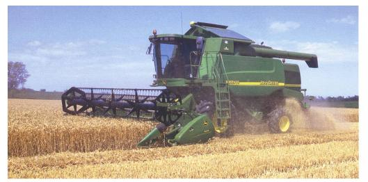
**John Deere** bringt vier neue Mähdrescherserien S, C, T, W. Die T-Baureihe mit vier Basismodellen zwischen 290 und 400 PS weist ein komplett neues Dreschkonzept mit zwei 660 mm grossen Dreschtrommeln und dazwischen liegender 420 Zuführtrommel auf. Das Paket Autotrac (Lenkautomatik), HarvestSmart (automatische Durchsatzregelung) und HarvestDoc (Ertrags- und Erntedatenerfassung) berechtigt zur Bezeichnung «i» für Intelligenz.
