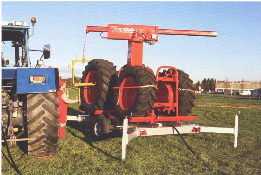
33 Neuheiten erhalten eine Agritechnica-Silbermedaille, unter ihnen der Twin Carrier der Gebrüder Schaad AG in Subingen SO. Das Gerät erlaubt es, Doppelräder im Einmannbetrieb auch auf nicht planbefestigter Unterlage zu montieren.
