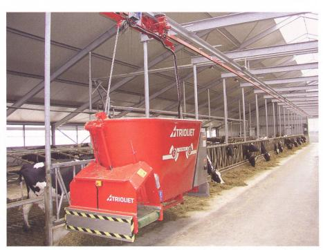
**Trioliet:** Automatische Fütterung Triomatic: Der Automat holt sich die zwischengelagerten Futterkomponenten nach der programmierten Rezeptur.
