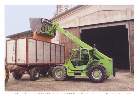
Merlo: Panoramic P 55.9 CS mit einem 140 PS Turbo Diesel sowie neuem Chassis und verstärktem Auslieger stösst von der Leistungsfähigkeit und Kapazität her in den Schwerlastbereich der Radlader vor.
