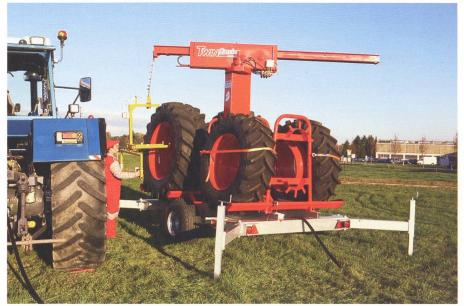
33 Neuheiten erhalten eine Agritechnica-Silbermedaille, unter ihnen der Twin Carrier der Gebrüder Schaad AG in Subingen SO. Das Gerät erlaubt es, Doppelräder im Einmannbetrieb auch auf nicht planbefestiger Unterlage zu montieren.
