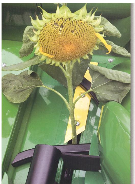
Kemper: Maispflückvorsatz Cornstar mit einem robusten Rotationseinzugssystem, umgerüstet für Sonnenblumen.
