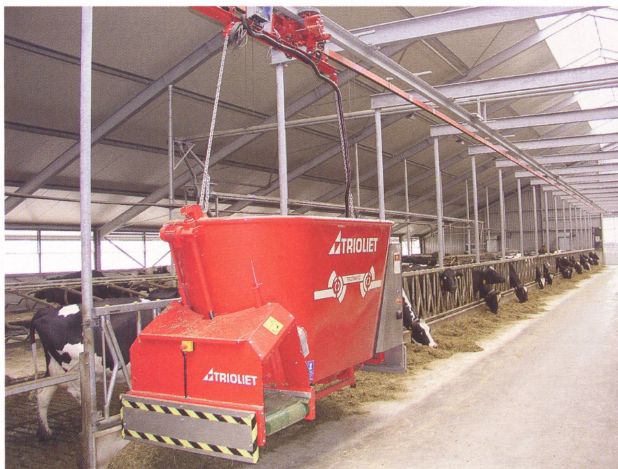
Trioliet: Automatische Fütterung Triomatic: Der Automat holt sich die zwischengelagerten Futterkomponenten nach der programmierten Rezeptur.
