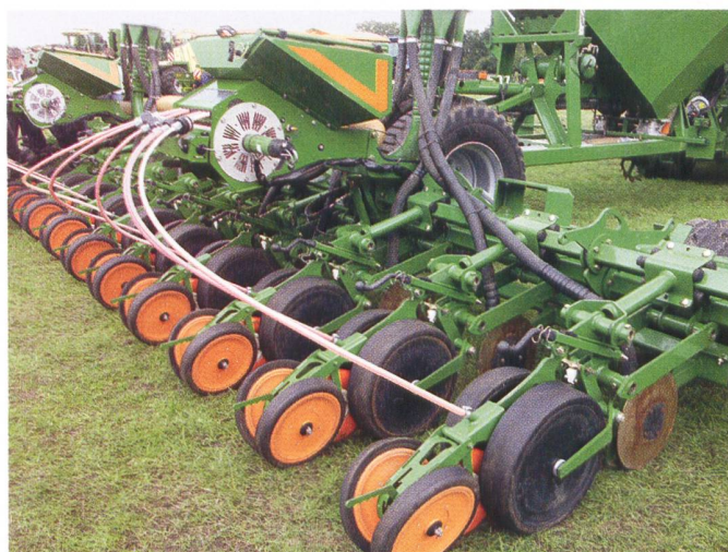
Einzelkornsätechnik: Völlig neues Prinzip mit zentraler Körnerdosierung.
