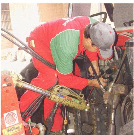
Die komfortable Lösung: Vier Steuerventile und die entsprechenden Hydraulikzylinder zur Bedienung von Oberlenker, Pflugdrehung, Schnittbreite des ersten Pflugkörpers und Variomat.
