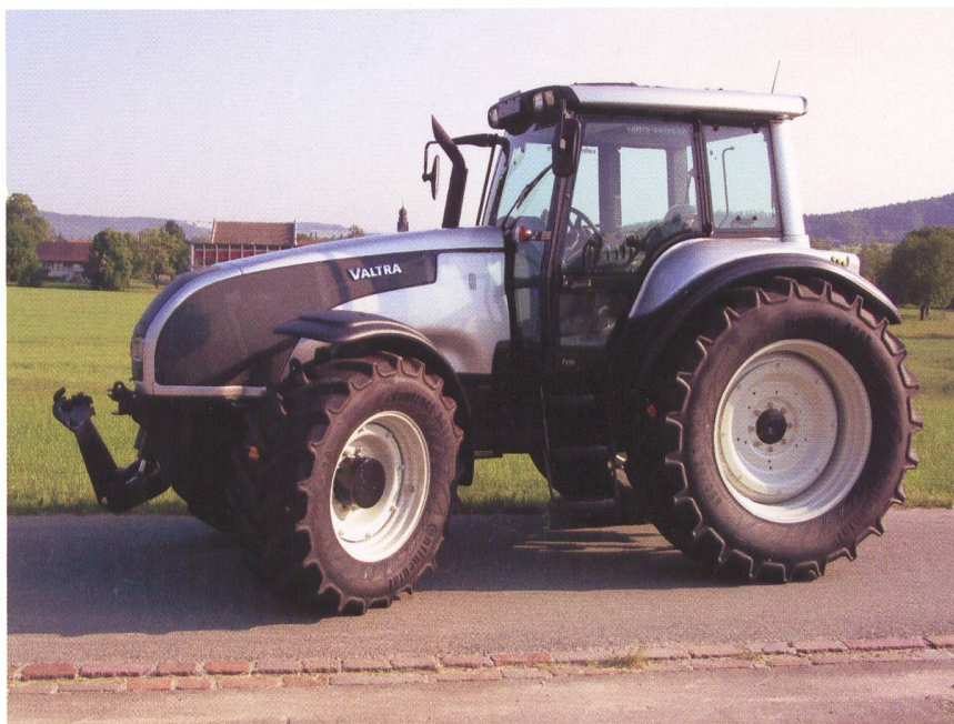
Abb. 5: Traktor Valtra T170cH, 6-Zylinder-Turbomotor mit Ladeluftkühlung, 132 kW (180 PS), drei Lastschaltstufen, Fronthydraulik, Vorderachsfederung, Gewicht 6650 kg, Testbericht Nr. 1910/06.
