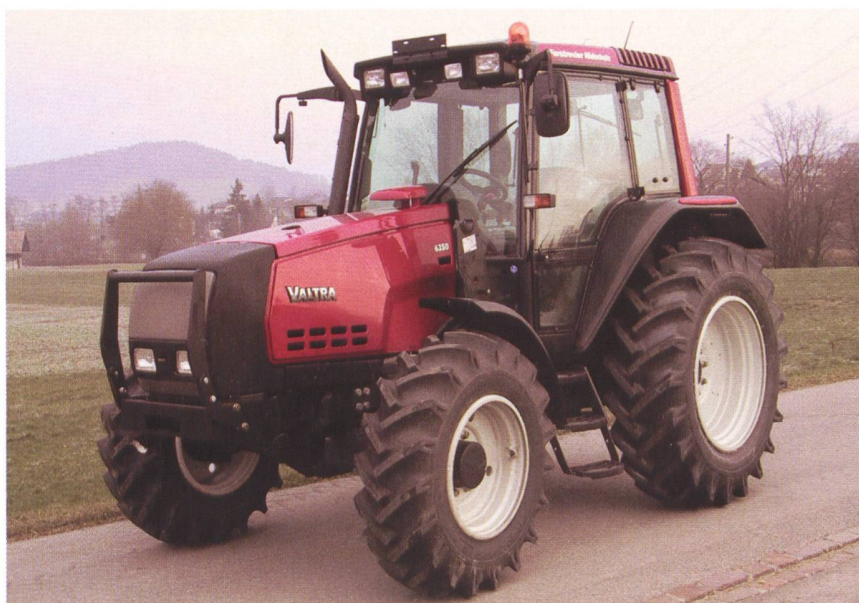
Abb. 1: Traktor Valtra 6350-4, 4-Zylinder-Turbomotor, 74 kW (101 PS), drei Lastschaltstufen, Gewicht 4610 kg, Testbericht Nr. 1902/06.
