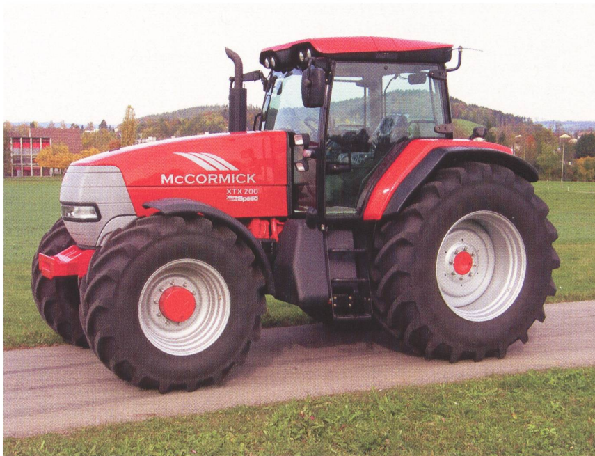
Abb. 3: Traktor Mc Cormick XTX200, 6-Zylinder-Turbomotor mit Ladeluftkühlung, 134 kW (182 PS), acht Lastschaltstufen, Vorderachs- und Kabinenfederung, Gewicht 7960 kg, Testbericht Nr. 1903/06.
