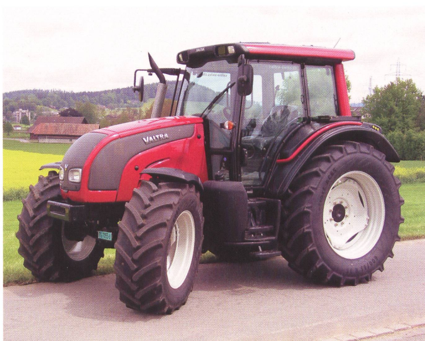
Abb. 4: Traktor Valtra N121 HiTech, 4-Zylinder-Turbomotor mit Ladeluftkühlung, 93 kW (126 PS), drei Lastschaltstufen, Vorderachsfederung, Gewicht 5460 kg, Testbericht Nr. 1909/06.
