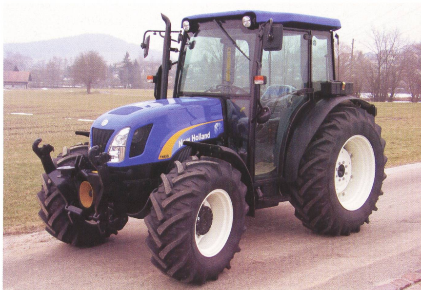
Abb. 2: Traktor New Holland TN 85DA, 4-Zylinder-Saugmotor, 60 kW (82 PS), Gewicht 3200 kg, Testbericht Nr. 1905/06.
