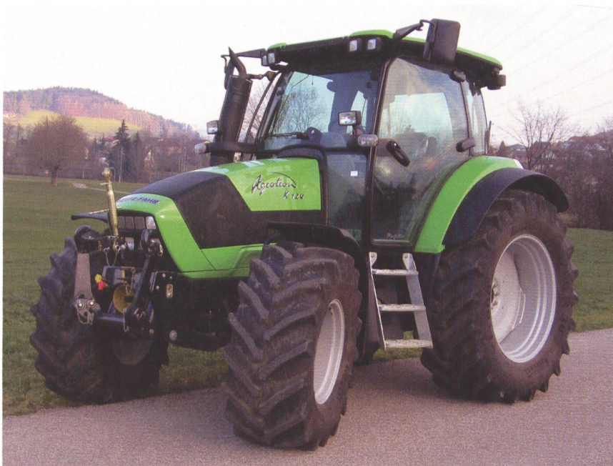
Abb. 6: Traktor Deutz Agrotron K120 Profiline, 4-Zylinder-Turbomotor mit Ladeluftkühlung, 85 kW (115 PS), drei Lastschaltstufen, Fronthydraulik und Frontzapfwelle, Vorderachs- und Kabinenfederung, Gewicht 5350 kg, Testbericht Nr. 1911/06.
