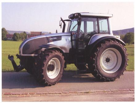
Abb. 5: Traktor Valtra T170cH, 6-Zylinder-Turbomotor mit Ladeluftkühlung, 132 kW (180 PS), drei Lastschaltstufen, Fronthydraulik, Vorderachsfederung, Gewicht 6650 kg, Testbericht Nr. 1910/06.
