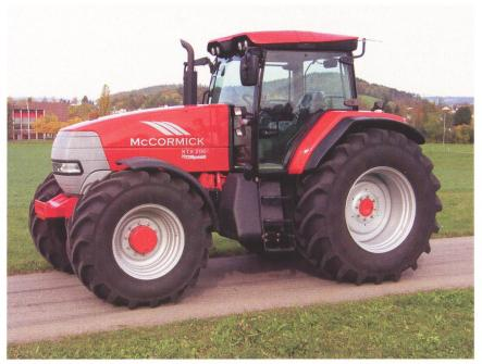
Abb. 3: Traktor Mc Cormick XTX200, 6-Zylinder-Turbomotor mit Ladeluftkühlung, 134 kW (182 PS), acht Lastschaltstufen, Vorderachs- und Kabinenfederung, Gewicht 7960 kg, Testbericht Nr. 1903/06.
