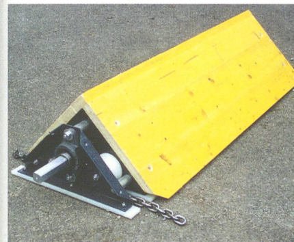
Der Schieber besteht aus einer dreieckigen Metallkonstruktion, abgedeckt mit Schalungselementen. Im Inneren befinden sich die Antriebsteile.
