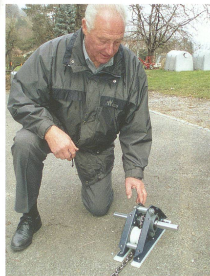
Konstrukteur Werner Schmidheiny zeigt die Kettenkatze, die über eine Welle vom Motor angetrieben wird.
