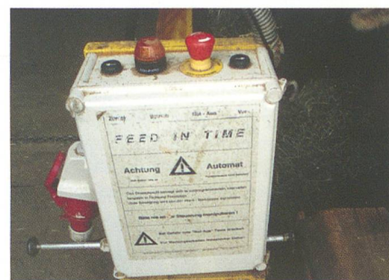
Die elektrotechnische Steuerung ist in einem Kasten untergebracht, der auf dem Schieber mitfährt. (Foto: Michael Götz)
