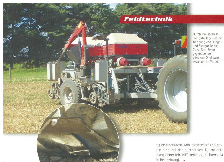
Durch ihre spezielle Saatgutablage und die Trennung von Dünger und Saatgut ist die Cross-Slot-Schar gegenüber den gängigen Direktsaatsystemen im Vorteil.
