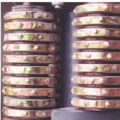
Abb. 5a: Der Einsatz von Rundlamellen ermöglicht eine feine Rillierung bei geringen Ausbrechungen.
