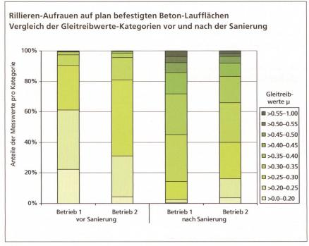
Abb. 12: Gleitreibwerte-Kategorien vor und nach der Sanierung mit Rillieren-Aufrauen auf planbefestigten Beton-Laufflächen der beiden Praxisbetriebe. Die Kategorien mit tiefen Werten ( $\leq 0,3~\mu$ ) widerspiegeln die Anteile mit geringer und jene > 0,35  $\mu$  solche mit hoher Rutschfestigkeit. Nach der Sanierung zeigen die Kategorien > 0,45  $\mu$  eine deutliche Zunahme der Makrorauheit.
