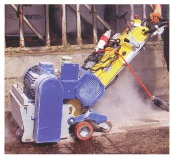
Abb. 4: Für das Fräsen von Rillen in homogener Form sind Geräte mit stufenlosem Fahrantrieb erforderlich. Minimale Geräte- und Werkzeuggewichte schonen das Betongefüge.
