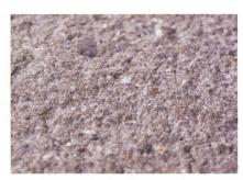
Abb. 9: Sanierungsverfahren Hochdruck-Wasserstrahl mit Strahlmittel 0,6–1 mm; erst durch komplettes Abtragen der Kalkschichten entsteht die erforderliche Rutschfestigkeit.
