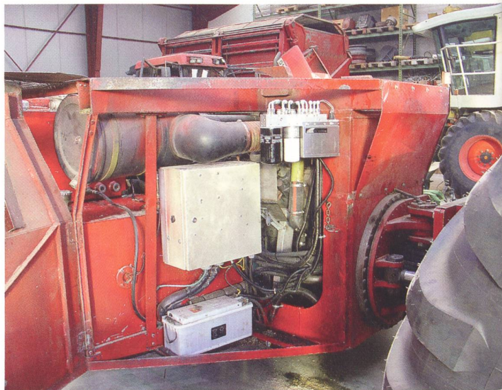
Zweitreibstoff-Kit vom Typ Bioltec ( www.bioltec.de ) auf einer selbstgebauten Häckselmaschine. Sie gehört Peter Stähli, Lohnunternehmer in Suberg.
