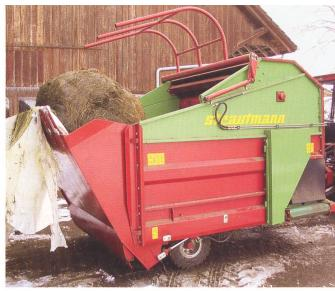
Abb. 3: Ein Universalblockverteilwagen (UBVW) mit Ladeklappe, hier beladen mit einer Rundballe, kann auch mit offenem Futter beschickt werden. (Bild: S. Schrade, Agroscope ART)
