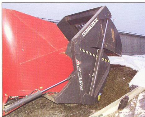
Abb. 6: Vertikalmischer werden in der Regel mit einer Schnecke, neu allerdings auch mit mehreren Schnecken gebaut (kompaktere Abmessungen). Es sind auch Modelle mit Entnahmevorrichtungen erhältlich. (Bild: F. Nydegger, Agroscope ART)
