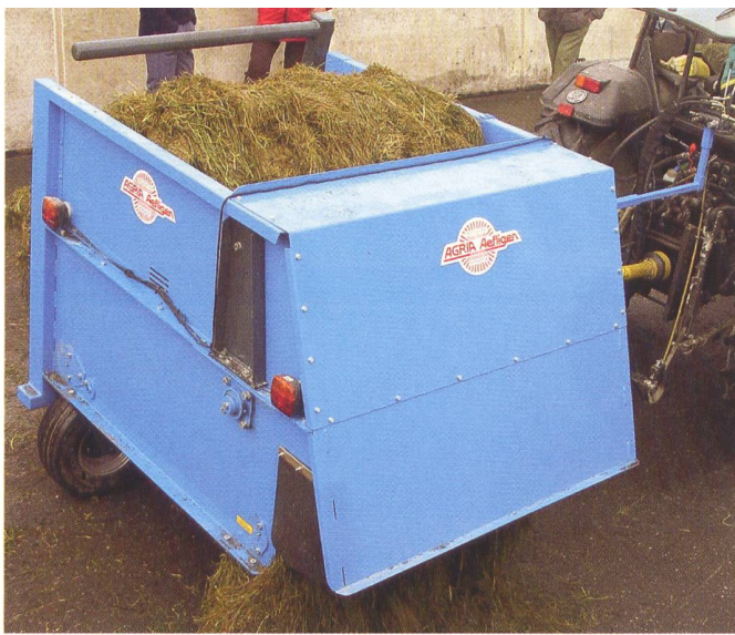
Abb. 2: Geschlossene, gezogene Ballenauflösegeräte mit Kratzboden als Vorschub und klingenbestückte Auflösewalze bei der Futtervorlage. Geschlossene Ballenauflösegeräte können aufgrund ihrer begrenzten Innenmasse nur runde, unverformte Ballen aufnehmen. (Bild: S. Schrade, Agroscope ART)
