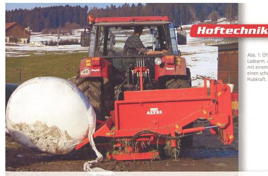
Abb. 1: Offene Ballenauflösegeräte: beladen mit Ladearm. Abwickeln und Vorlage von Silageballen mit einem Gerät im Dreipunktanbau erfordern einen schweren Traktor mit entsprechender Hubkraft. (Bild: S. Schrade, Agroscope ART)
