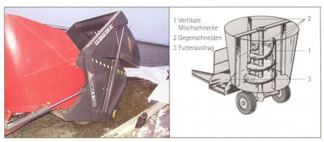
Abb. 6: Vertikalmischer werden in der Regel mit einer Schnecke, neu allerdings auch mit mehreren Schnecken gebaut (kompaktere Abmessungen). Es sind auch Modelle mit Entnahmevorrichtungen erhältlich. (Bild: F. Nydegger, Agroscope ART)
