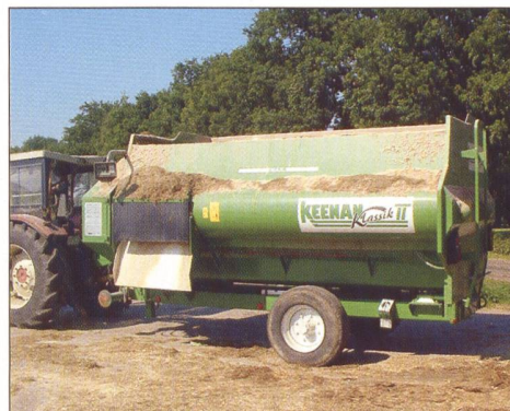
Abb. 8: Freifall- oder Paddelmischer gelten als besonders futterschonend. Sie sind weniger geeignet für das Mischen von längeren Futterkomponenten wie Heu oder Stroh. (Bild: H. Brunken, Agroscope ART)
