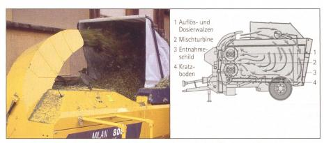
Abb. 7: Umlauf- oder Turbinenmischer sind weniger verbreitet. Sie eignen sich auch zum Einstreuen. (Bild: F. Nydegger, Agroscope ART)
