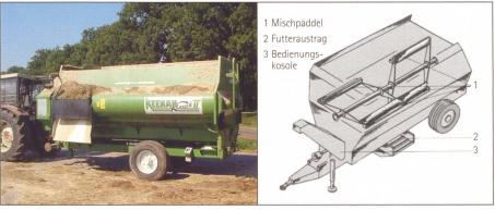
Abb. 8: Freifall- oder Paddelmischer gelten als besonders futterschonend. Sie sind weniger geeignet für das Mischen von längeren Futterkomponenten wie Heu oder Stroh. (Bild: H. Brunken, Agroscope ART)
