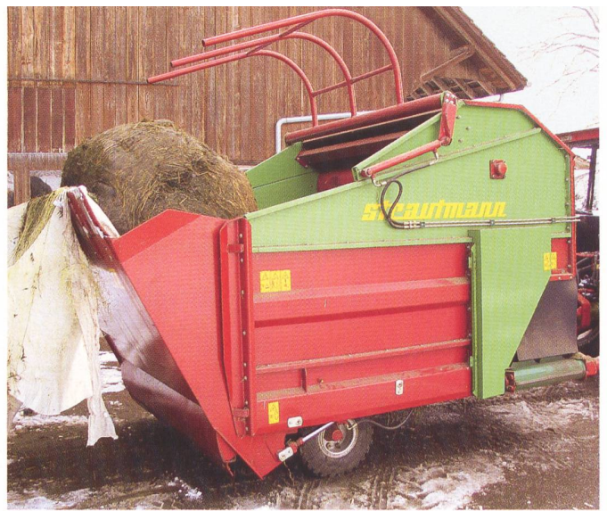
Abb. 3: Ein Universalblockverteilmwagen (UBVW) mit Ladeklappe, hier beladen mit einer Rundballe, kann auch mit offenem Futter beschickt werden. (Bild: S. Schrade, Agroscope ART)
