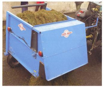
Abb. 2: Geschlossene, gezogene Ballenauflösegeräte mit Kratzboden als Vorschub und klingenbestückte Auflösewalze bei der Futtervorlage. Geschlossene Ballenauflösegeräte können aufgrund ihrer begrenzten Innenmasse nur runde, unverformte Ballen aufnehmen. (Bild: S. Schrade, Agroscope ART)
