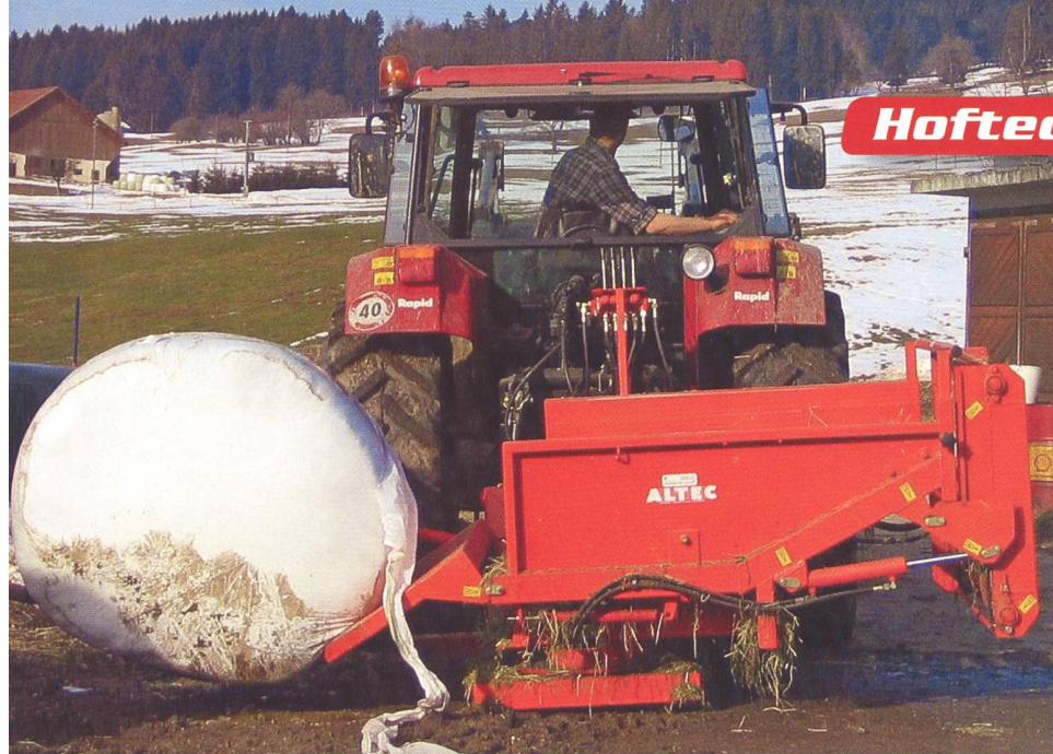
Abb. 1: Offene Ballenauflösegeräte: beladen mit Ladearm. Abwickeln und Vorlage von Silageballen mit einem Gerät im Dreipunktanbau erfordern einen schweren Traktor mit entsprechender Hubkraft. (Bild: S. Schrade, Agroscope ART)
