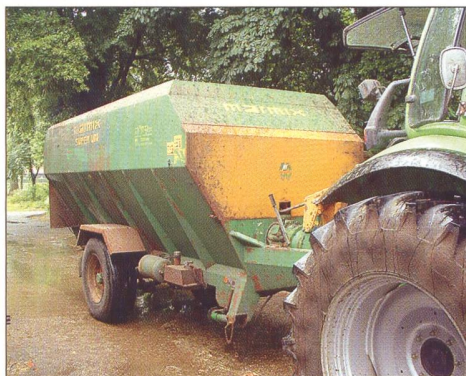
Abb. 5: Horizontalmischwagen weisen 1 bis 4 Schnecken auf. Sie eignen sich aufgrund ihrer Abmessungen gut für enge und relativ niedrige Durchfahrten. (Bild: H. Brunken, Agroscope ART)
