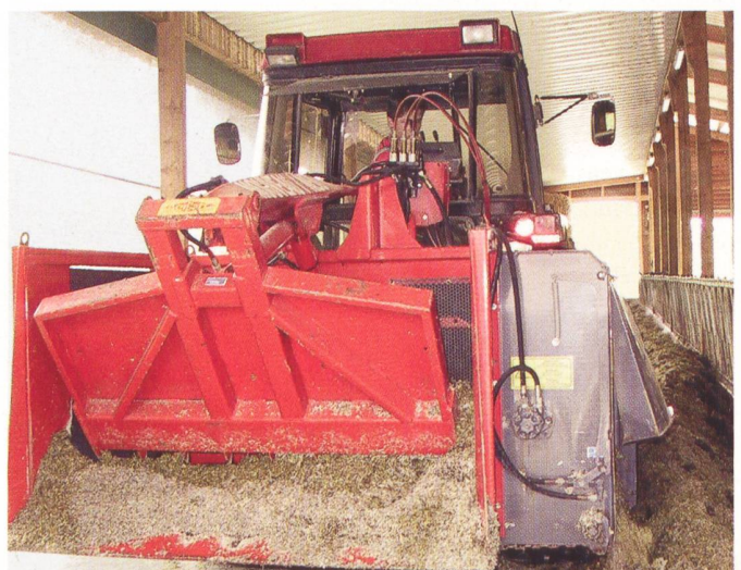
Abb. 4: Am Dreipunkt angehängte Entnahme-, Transport- und Verteilgeräte erlauben gutes Manövrieren, sie benötigen aber einen relativ starken Traktor. Die Entnahme erfolgt bei diesem Gerät mit einem Reisskamm. (Bild: R. Stark, Agroscope ART)
