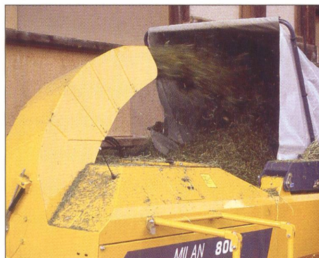
Abb. 7: Umlauf- oder Turbinenmischer sind weniger verbreitet. Sie eignen sich auch zum Einstreuen. (Bild: F. Nydegger, Agroscope ART)
