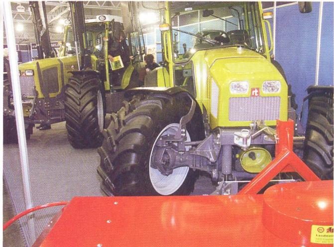
Sepp Knüsel präsentierte an der Agritechnica erstmals seinen neuen RigiTrac SKH 90. Er ersetzt den SKH 80 und ist statt mit einem ölf/luftgekühlten Motor nunmehr mit einem wassergekühlten 90 PS SISU-Motor ausgestattet. (Bild Zw.)
