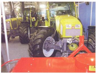
Sepp Knüsel präsentierte an der Agritechnica erstmals seinen neuen RigiTrac SKH 90. Er ersetzt den SKH 80 und ist statt mit einem öl/luftgekühlten Motor nunmehr mit einem wassergekühlten 90 PS SISU-Motor ausgestattet. (Bild Zw.)
