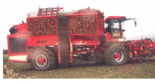
Hoher Stellenwert der Zuckerrübe im Betrieb und Lohnunternehmen Pavillard: Schwere Erntetechnik sichert Kapazität und Leistungsfähigkeit, die Breitbereifung dank grosser Kontaktfläche einen erträglichen Bodendruck.
