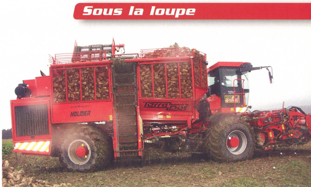
Hoher Stellenwert der Zuckerrübe im Betrieb und Lohnunternehmen Pavillard: Schwere Erntetechnik sichert Kapazität und Leistungsfähigkeit, die Breitbereifung dank grosser Kontaktfläche einen erträglichen Bodendruck.
