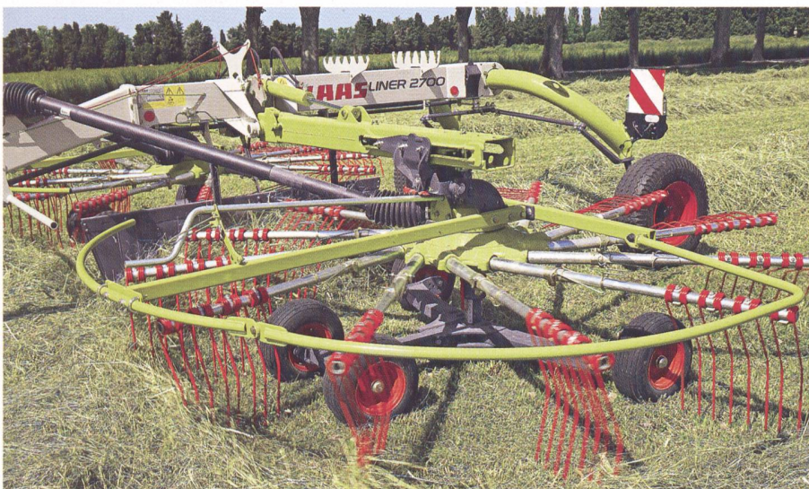
Liner 2600 / 2700 / 2800 ersetzen die Mittenschwader 680 / 780 / 880 Profil. Die nach allen Seiten beweglich aufgehängten Kreisel sind serienmässig mit einem 4-Rad-Laufwerk ausgerüstet. Ohne Abnahme der Zinkenarme wird eine Transporthöhe von weniger als 4 m erreicht.
