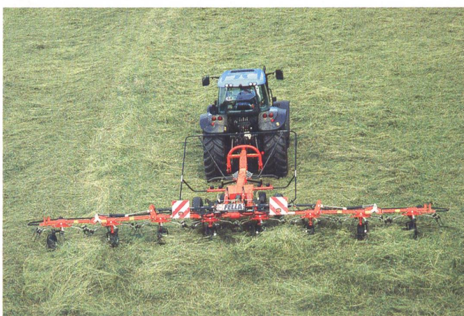
Turboheuer TH 901 und 1101 Schlepperanhangung neu mit Unterlenkeranhangung. Nacheinander können durch eine hydraulische Folgesteuerung die äusseren Kreise eingeschwenkt, die Seitenteile ausgehoben sowie das Transportfahrzeug ausgefahren und die Maschinen in Transportstellung gebracht werden (und umgekehrt).
