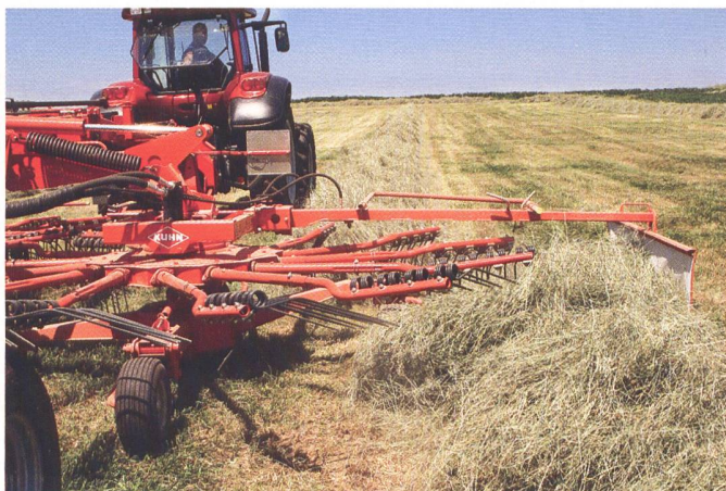
Gezogener Seitenschwader GA 8020 jetzt mit hydraulischem Kreiselantrieb.
