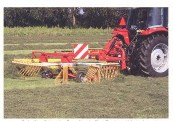
Twin-Disc Schwader-Baureihen in Ein-, Zwei- und Vierkreiselvarianten. Durch zwei gross dimensionierte Kugellager wartungsfreie Lagerung der Zinkenarme. Die schräggestellen Sekundärzinken sollen auch bei hoher Geschwindigkeit die saubere und vollständige Futteraufnahme gewährleisten.
