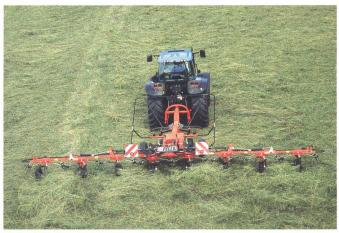
Turboheuer TH 901 und 1101 Schlepperanhängung neu mit Unterlenkeranhängung. Nacheinander können durch eine hydraulische Folgesteuerung die äusseren Kreisen eingeschwenkt, die Seitenteile ausgehoben sowie das Transportfahrzeug ausgefahren und die Maschinen in Transportstellung gebracht werden (und umgekehrt).
