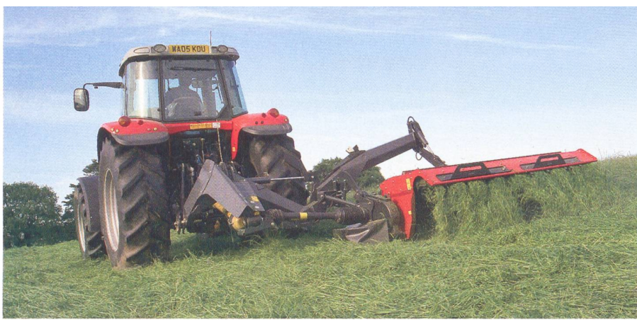
Gezogen aufgehängtes Heck-Anbaumähwerk mit Aufbereiter von Vicon (Kverneland). Die Aufhängung garantiert eine hervorragende Boden Anpassung.
