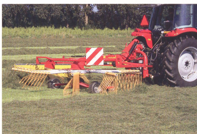
Twin-Disc Schwader-Baureihen in Ein-, Zwei- und Vierkreiselvarianten. Durch zwei gross dimensionierte Kugellager wartungsfreie Lagerung der Zinkenarme. Die schräggestellten Sekundärzinken sollen auch bei hoher Geschwindigkeit die saubere und vollständige Futteraufnahme gewährleisten.
