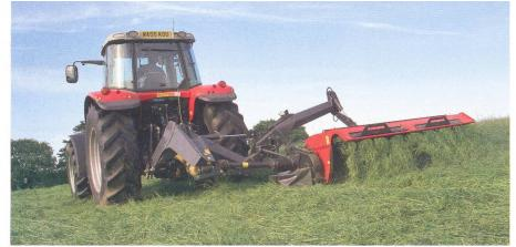
Gezogen aufgehängtes Heck-Anbaumähwerk mit Aufbereiter von Vicon (Kverneland). Die Aufhängung garantiert eine hervorragende Bodenanpassung.
