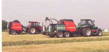
Ihr Traktor ISOBUS-kompatibel, erkennt die Traktorelektronik die Ballenpresse, und Sie können auf einfache Weise die Presse über die Bedienkonsole des Traktors steuern.
