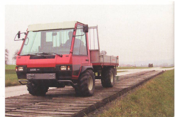
Abb. 2: Versuchsfahrten mit Geschwindigkeiten von 10 bis 30 km/h auf der normierten 100-m-Holperbahn, die eine Feldweg-Charakteristik aufweist.
