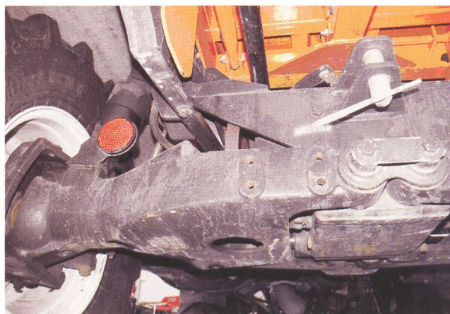
Abb. 8: Die Pendelachse des Lindner Unitrac 95 ist in massiver Konstruktion als Einfach-Dreieck-Querlenker ausgebildet.
