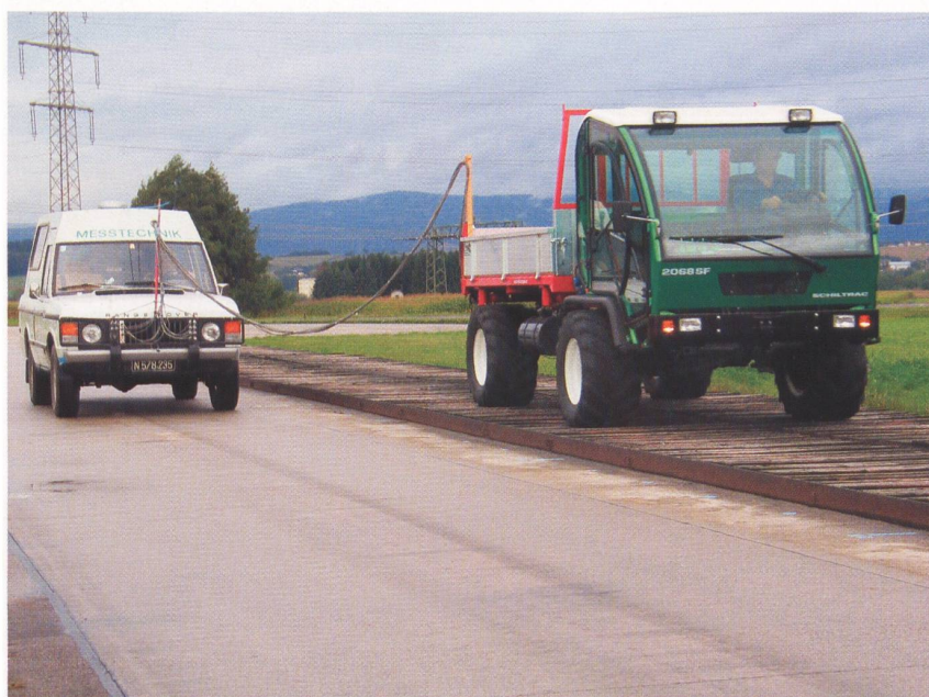
Abb. 1: Die Beurteilung der Belastung der Fahrerin oder des Fahrers durch Schwingungen erfolgt definiert und reproduzierbar auf normierten Holperbahnen.
