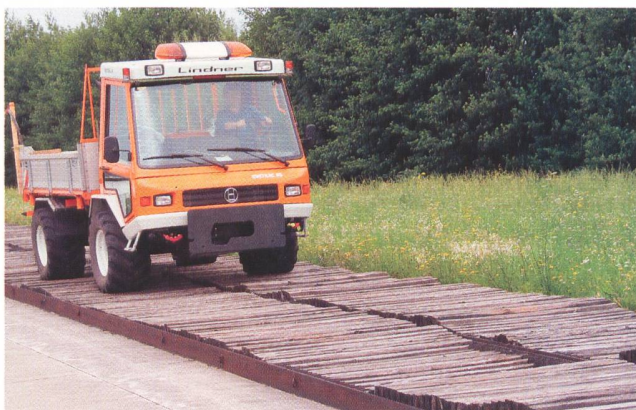
Abb. 3: Versuchsfahrten mit 3, 4 und 5 km/h auf der normierten 35-m-Holperbahn, welche die Charakteristik eines gepflügten Ackers aufweist.
