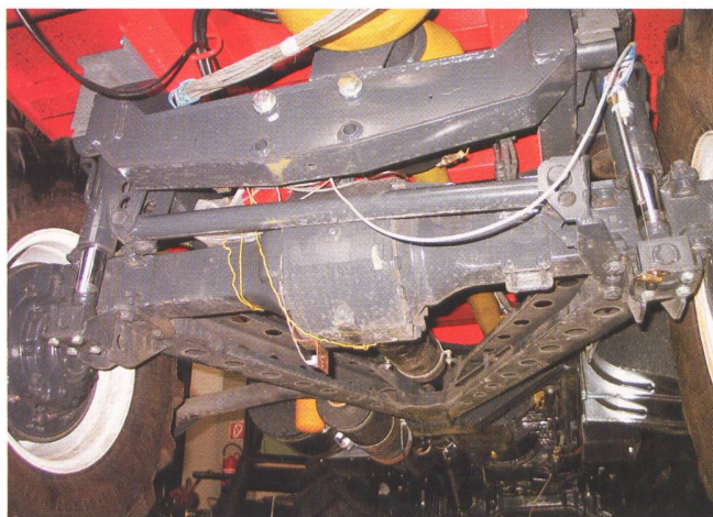
Abb. 10: Beim Schiltrac 2068SF sind die Starrachsen durch einen langen Dreieckrahmen geführt und vor den Achsen gelenkig am Fahrzeugrahmen abgestützt. Die beiden Federungs- zylinder bilden nahe der Räder die Verbindung zwischen Achse und Rahmen. Gut sichtbar der kräftige Querstabilisator zur Aufnahme der Seiten- kräfte.
