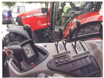
X-Line: Semi-Powershift-Getriebe  $16 \times 16$  mit Feld und Strassenmodus. Rechts: mechanische Ansteuerung der Hydraulik-Zusatzsteuergeräte.
