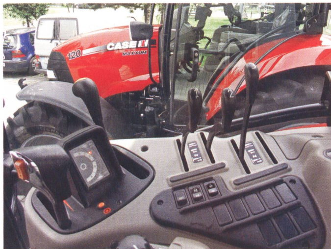
X-Line: Semi-Powershift-Getriebe 16 x 16 mit Feld und Strassenmodus. Rechts: mechanische Ansteuerung der Hydraulik-Zusatzsteuergeräte.
