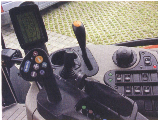
Alle wichtigen Funktionen wie Powershift und Powershuttle (Reversiergetriebe) und die Bedienelemente für die Hydraulikventile sind im «Multicontroller III» in der rechten Armlehne integriert.
