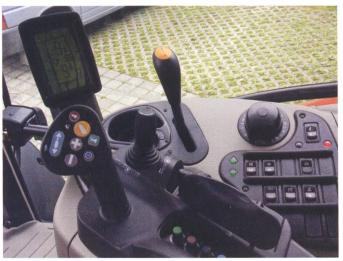
Alle wichtigen Funktionen wie Powershift und Powershuttle (Reversiergetriebe) und die Bedienelemente für die Hydraulikventile sind im «Multicontroller III» in der rechten Armlehne integriert.
