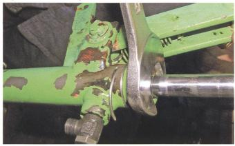
Andreas hat den undichten Hydraulikzylinder seines Kreiselheuers demontiert und mitgebracht. Wie die unterschiedlichen Zylinder zu öffnen sind und wann es sich noch lohnt, Manschetten und Dichtringe zu ersetzten, wird ausführlich diskutiert und erklärt.
