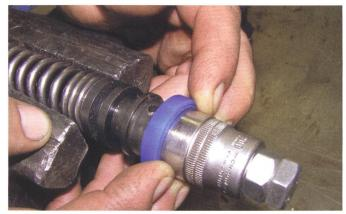
Eine neue Manschette konnte im Fachhandel beschafft werden. Nun muss diese montiert werden, ohne die Dichtlippen an den Kanten des Kolbens zu verletzen. Gewusst wie: Der Trick mit der passenden Steckschlüssel-Nuss und heissem Wasser funktioniert.
