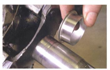
Abhilfe schafft hier die gezeigte Wellenschonhülse, im Fachhandel in allen Durchmessern erhältlich. Sie wird über die Welle geschoben, so dass der neue Simmering wieder auf einer glatten Fläche läuft. (Bilder: Hansueli Schmid
