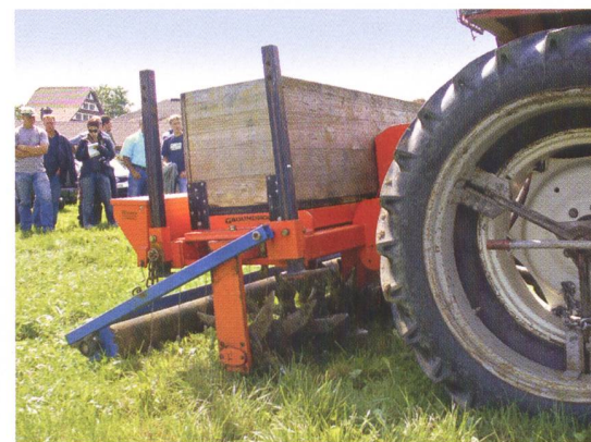
Groundhog: Eine Art Spatenrollegge reisste die Verfilzung auf und sticht Löcher in den Boden.
