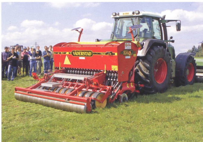
Der hohe Schardruck der Direktsaatmaschine sorgt für die Ablage des Samens in der gewünschten Tiefe.
