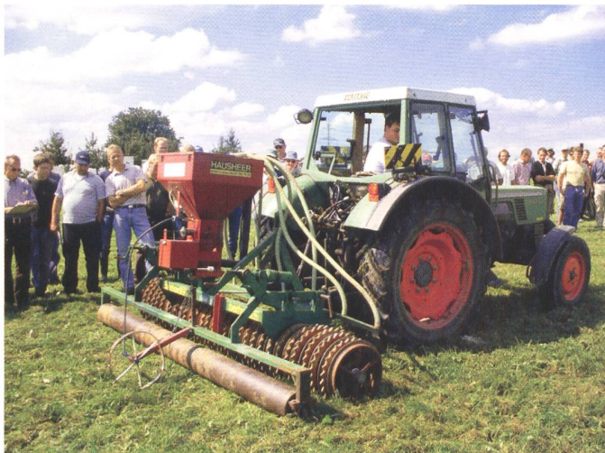
Glattwalzen werden vom bestehenden Altbestand angehoben und verrichten deshalb die Arbeit weniger gut als Rauwalzen (Bild).
