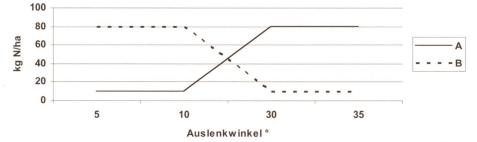
Abb. 1. Düngestrategien mit Crop-Meter: In Funktion des Auslenkwinkels des Pendels kann die gewünschte Düngemenge gewählt werden. Strategie A: Der Landwirt wählt höhere Düngegaben bei höherer Auslenkung und somit dichten Beständen, bei Strategie B ist dies umgekehrt.
