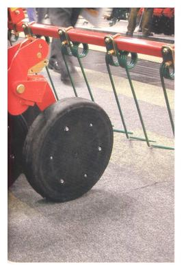
Abb. 1 Im Vergleich zu konventionellen Scheibenscharen mit Schardrücken um die 10 kg (links) benötigt die Führung von Scheibenscharen mit hohen Schardrücken (zirka 80 kg), zusätzliche Tiefenführungsrollen (rechts). Sie ermöglichen die Saat in grobe, mit Stroh durchsetzte Saatbetten.
