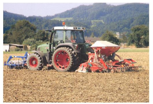
Abb. 2 Pneumatische Sämaschinen lassen sich einfach abdrehen und der Saatgutbehälter lässt sich leicht entleeren, die Dosiergenauigkeit ist hingegen nicht besser als bei mechanischen Sämaschinen.
