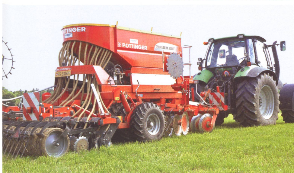
Abb. 6 Sämaschinen werden immer komplexer, weshalb die Elektronik zu einem wichtigen Bestandteil wird. Statt jede Maschine mit einem eigenen Bedienterminal auszurüsten, hält der ISO-Bus nun auch bei den Sämaschinen Einzug. So ist es möglich, die Sämaschine mit dem Traktorterminal zu steuern – ein begrüssenswerter Schritt Richtung Zukunft!
