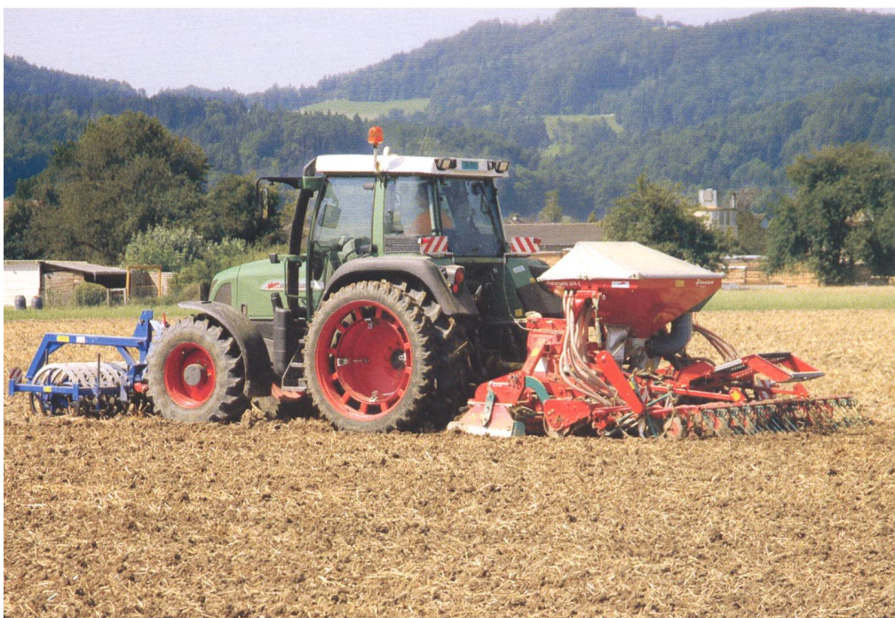
Abb. 2 Pneumatische Sämaschinen lassen sich einfach abdrehen und der Saatgutbehälter lässt sich leicht entleeren, die Dosiergenauigkeit ist hingegen nicht besser als bei mechanischen Sämaschinen.
