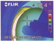
Die Wärmebildkamera zeigt die heissen Partien bei der Bremsanlage: Die dunklen Farben von Achse (mitte-rechts) und Reifen (links) deuten auf tiefe Temperaturen hin. Die Bremstrommel ist dagegen vor allem im Bereich der Bremsbacke (weisser Halbmond links) stark aufgeheizt (Foto ART).
