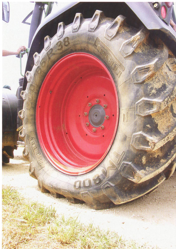
Abb. 5: Die Reifentragfähigkeit ist abhängig vom Reifeninnendruck und von der Fahrgeschwindigkeit.
