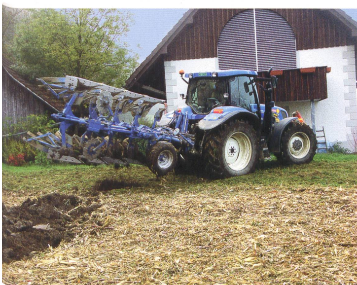
Abb. 4: Um problemloses Lenken zu gewährleisten, sollten gemäss VTS 20 Prozent des Betriebsgewichtes auf der Lenkachse sein.
