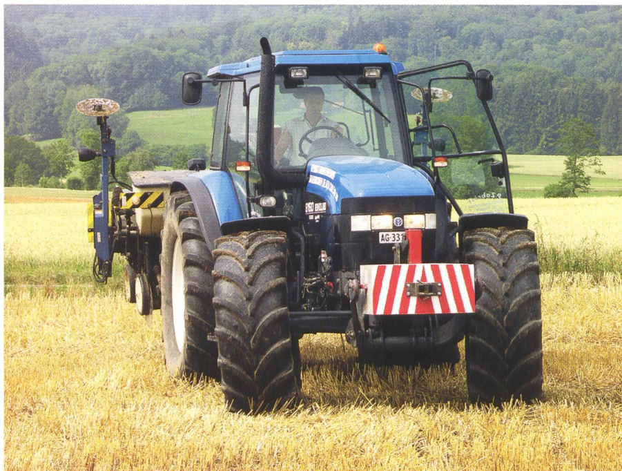
Frontballastierung gewährleistet eine günstige Verteilung des Betriebsgewichts auf die beiden Achsen.
