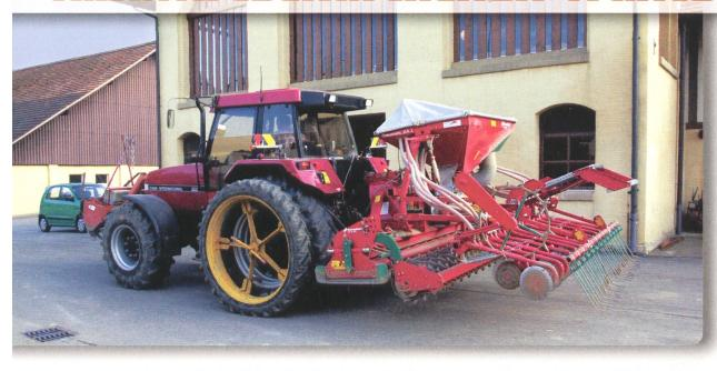
Abb. 1: Schwere Anbaugeräte bedingen hohe Nutzlasten.
