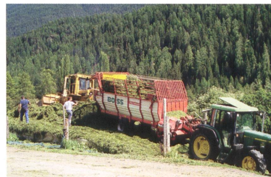
Am nächsten Tag wird einsiliert. Die Schlagkraft bringt der Pöttinger Kurzschnittdewagen mit Knickdeichsel und zum Pressen auf dem Fahrsilo ein ausgeliehener Pneulader. (Bild: Leta à Porta)
