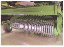
Krone «EasyFlow»-Pickup mit geringem Verschleiss, hoher Durchsatzleistung und optimaler Bodenanpassung.
