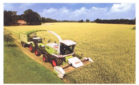
Leistungsfähige GPS-Ernte in einem Arbeitsgang: Claas Jaguar mit Direktschneidwerk «Direct-Disc 520»
