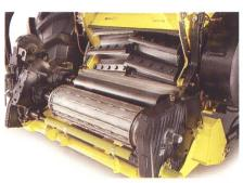
«Das grosse NH Häckselaggregat und viele Automatikfunktionen sind ausgelegt für hohen Durchsatz ohne Lastschankungen, optimale Häckselleistung und günstige Verbrauchswerte».
