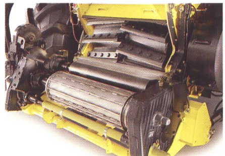
«Das grosse NH Häckselaggregat und viele Automatikfunktionen sind ausgelegt für hohen Durchsatz ohne Lastschankungen, optimale Häckselleistung und günstige Verbrauchswerte».
