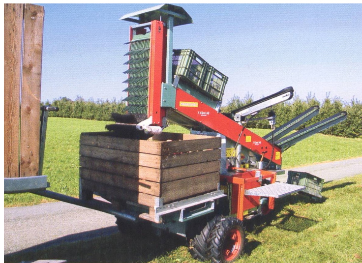
Abb. 2: Der Kistenfüller des Erntegerätes Pluko-trak ermöglicht eine gleichmässige Verteilung des Ernteguts in der Grosskiste.
