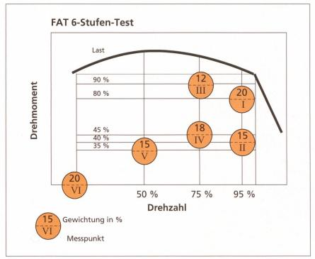
Abb. 3: 6-Stufen- Messzyklus
