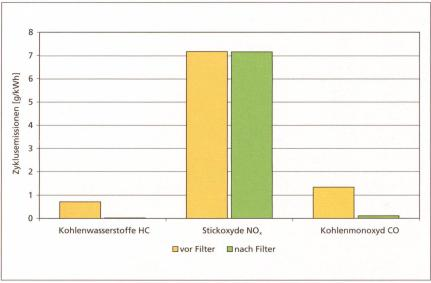
Abb. 5: Einfluss eines CRT-Systems auf die Zyklusemissionen der übrigen Abgasbestandteile: CO und HC werden massiv reduziert,  $NO_x$  bleibt unbeeinflusst. Gemessen am Valtra 6350-4 rot.
