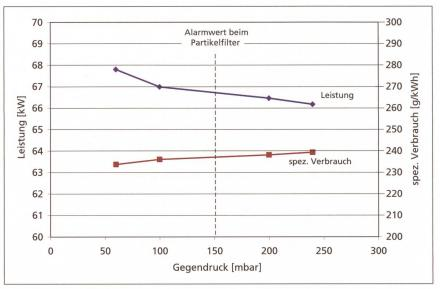
Abb. 7: Einfluss des Abgasgegendruckes auf Nennleistung und spezifischen Verbrauch beim Motor S.L.H. 1000.4WT.
