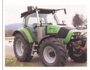
Motorleistung: Abgasstufe: Filterprinzip: Filterhersteller: Einbaufirma: Einbau: Filterstunden: Einsatzbereich: 70 kW nach ECE Stufe 2 Elektrische Beheizung Johnson Matthey Minelli AG 16.12.2005 bei 20 Stunden mehr als 472 Stunden Transport und Ackerarbeiten, Gülle ausbringen
