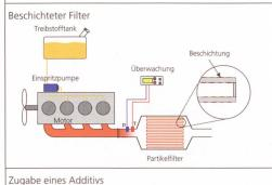
Durch den Kontakt des Russes mit der Beschichtung, beispielsweise Platin, reagiert dieser bei niedrigen Temperaturen mit Sauerstoff und verbrennt zu Kohlendioxid CO<sub>2</sub>. Auch hier werden je nach Beschichtung Kohlenwasserstoffe HC und Kohlenmonoxid CO reduziert, gleichzeitig kann aber durch Oxidation auch mehr NO<sub>2</sub> entstehen.
