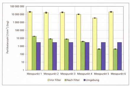
Abb. 4: Wirkungsgrad eines Partikelfilters bei den sechs Messpunkten des FAT-Messzyklus. Die Partikelanzahl ist auf einer logarithmischen Skalierung aufgezeichnet. Jeder Teilstrich der Skalierung ist um jeweils Faktor zehn höher als der darunterliegende.
