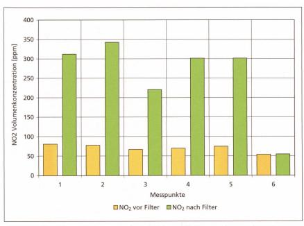
Abb. 6: Einfluss eines CRT-Systems auf  $NO_2$  bei den sechs Messpunkten. Bei CRT-Systemen kann ein  $NO_2$ -Schlupf entstehen, wenn mehr  $NO_2$  aufoxidiert wird, als für die Regeneration benötigt wird. Gemessen am Valtra 6350-4 rot.
