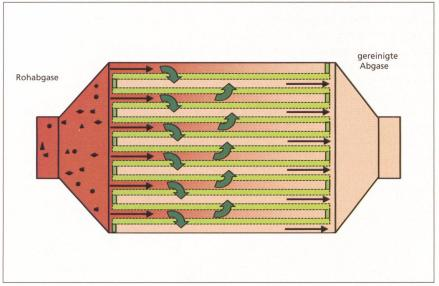
Abb. 2: Schema eines Partikelfilters.
