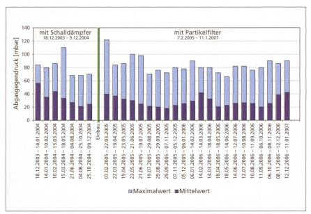
Abb. 8: Gegendruckaufzeichnung durch Datenlogger beim Lindner Geotrac 65
