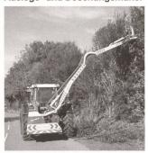
Vom Twiga 3000 mit einer waagrechten Reichweite von 3,2 m bis zum Twiga 7000 Tele mit einer senkrechten Reichweite von 8 m für Heck- oder Frontanbau ist für alle Einsätze die richtige Maschine vorhanden. Der Spiralrotor überzeugt durch ruhige Fahrt, gleichmässige Durchströmung, hohe
