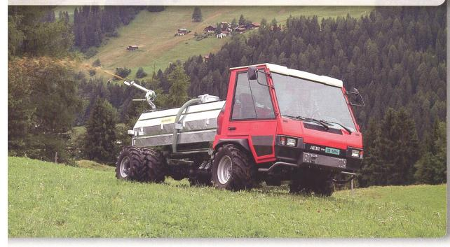
Transporter AEBI TP 68 mit Pumpfassfass Kuratli. Das Fass ist so konstruiert, dass der Schwerpunkt möglichst tief zu liegen kommt.
