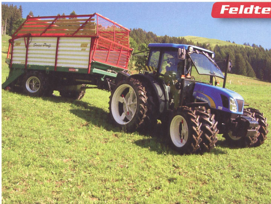
Traktor mit Sattelanhänger und gelenkter Triebachse von Urs Schmid, Littau. Aufgebaut ein Ladegerät der Firma Lüönd. Die Knickdeichsel – gesteuert durch einen Fühler im Pick-up – verbessert die Boden Anpassung.
