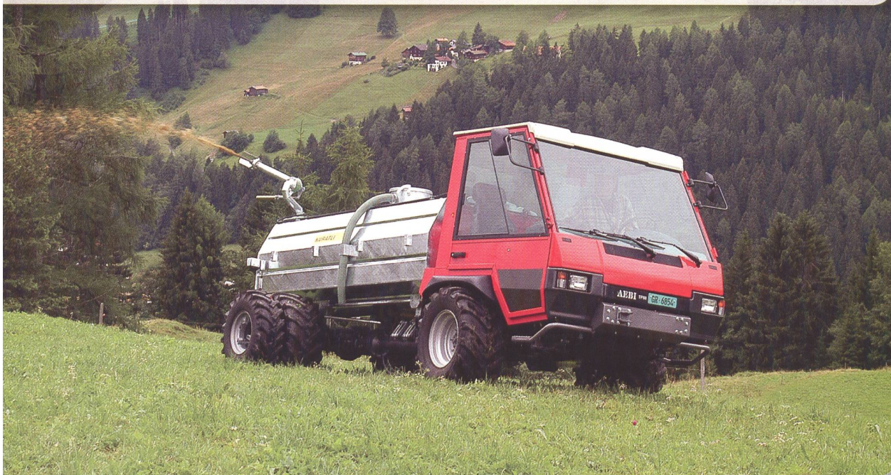
Transporter AEBI TP 68 mit Pumpfass Kuratli. Das Fass ist so konstruiert, dass der Schwerpunkt möglichst tief zu liegen kommt.
