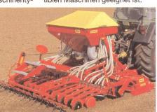
Diese elektronischen Steuerungen in Kombination mit einem elektrischen Dosiergeräteantrieb ermöglichen eine äusserst präzise, allen Bodenverhältnissen angepasste Saatmengenregulierung.
