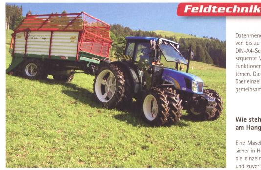
Traktor mit Sattelanhänger und gelenkter Treibachse von Urs Schmid, Littau. Aufgebaut ein Ladegerät der Firma Lüönd. Die Knickdeichsel – gesteuert durch einen Fühler im Pick-up – verbessert die Bodenanpassung.
