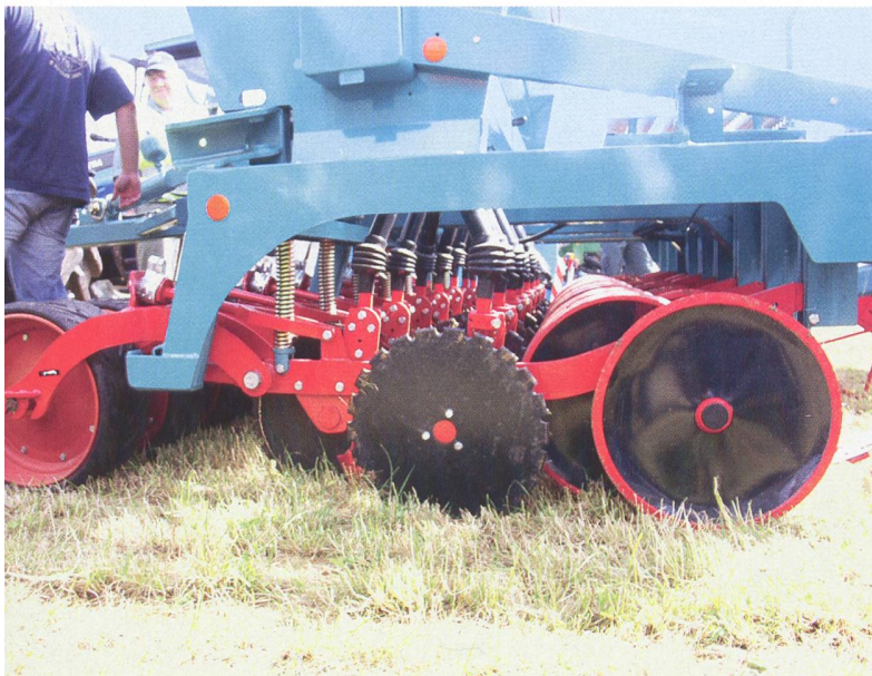
Kompakte Bauweise der Sulky Unidrill (Bovet SA) mit Einscheibensäscharren und mechanischer Saatgutzufuhr.
