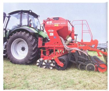
Kuhn Direktsaat: Ein Drehgelenk auf der Höhe des Reifenpackers sorgt für die spurgetreue Führung der Säschare in den von den Riffelscheiben aufgeritzten Rillen.
