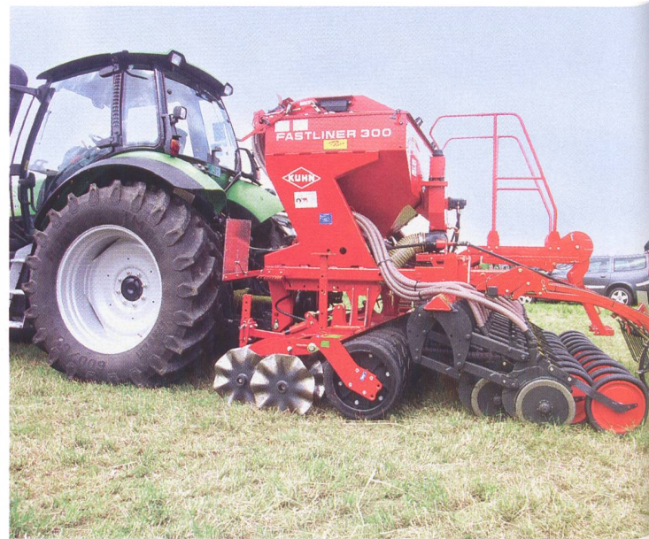
Kuhn Direktsaat: Ein Drehgelenk auf der Höhe des Reifenpackers sorgt für die spurgetreue Führung der Säscharre in den von den Riffelscheiben aufgeritzten Rillen.
