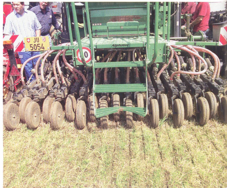
Nach Direktsaat – ein Säschlitz und sonst nichts: Präzise Saatgutablage mit Scheibenscharen der amerikanischen Marke Great Plains, die von Alphatec vertreten wird.
