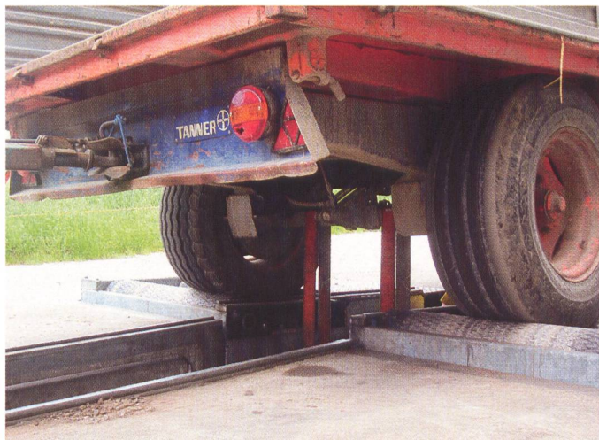
Für den Bremstest wird jede einzelne Achse mit zwei Gurten satt abgespannt. Anschliessend wird die Rolle hochgefahren, bis die zugelassene Achslast genau simuliert ist. (Foto: BVLT)
