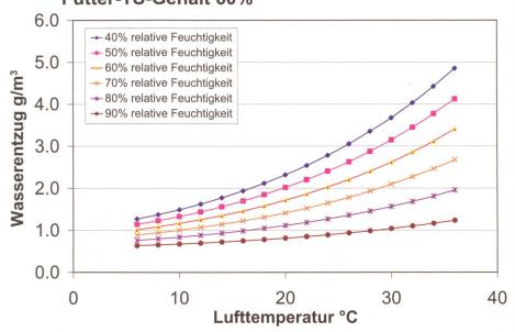
Abb. 5: Der Wasserentzug in Gramm Wasser pro m3 Luft hängt stark von der Lufttemperatur und der relativen Luftfeuchtigkeit (% rel. F.) ab. Die Kurven gelten für Futter mit 60% TS.
