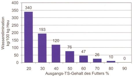
Abb. 4: Der TS-Gehalt des eingeführten Welkheus hat einen grossen Einfluss auf die Menge des zu eliminierenden Wassers. TS-Gehalte unter 55% sind vor allem bei grösseren Einführmengen kritisch
