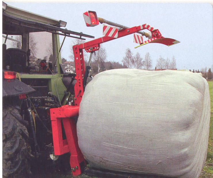
Abb. 1: Ein zusätzlicher hydraulisch betätigter Arm mit Zusatzbeleuchtung fixiert den Rundballen auf der Ballengabel (Anpresskraft zirka 5000 N, oder ca. 500 kg).
