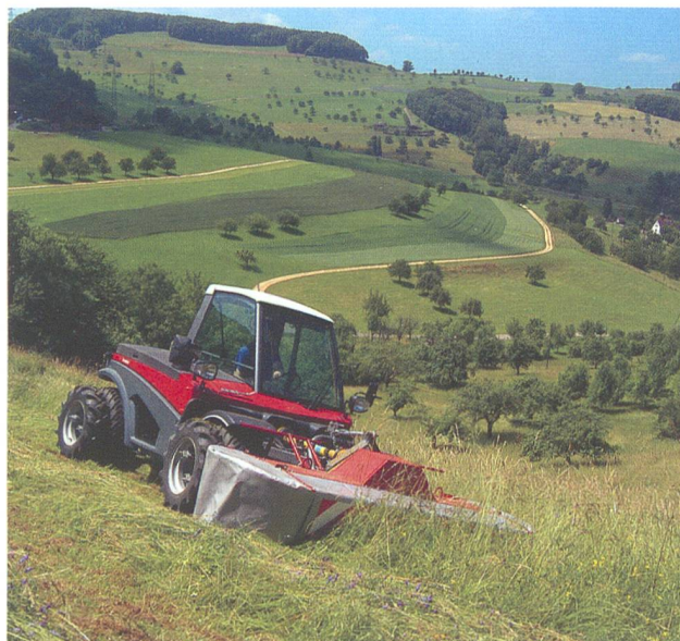
Aebi TT 170: Kompakte Maschinen im Einsatz mit einem Scheibenmäherwerk. Zweiachsmäher werden immer leistungsfähiger, weil sie auch mit breiten Mäherwerken bis 3 Meter eingesetzt werden.
