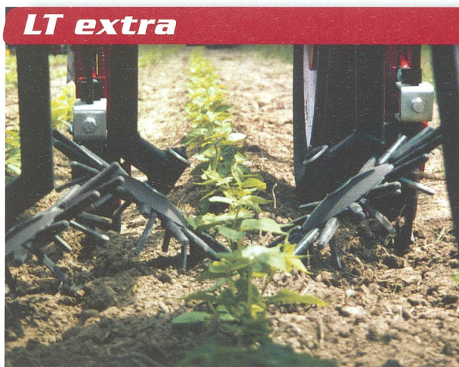
Trennhacke (links) und Fingerhacke (rechts) erfassen das Unkraut auch in der Reihe. Sie sind in der Anschaffung und im Unterhalt relativ teuer
