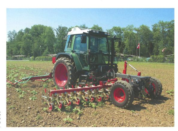
Scharhackgerät vorn, Striegel hinten. Geräte mit 6 oder gar 9 Meter Arbeitsbreite erhöhen die Leistungsfähigkeit..
