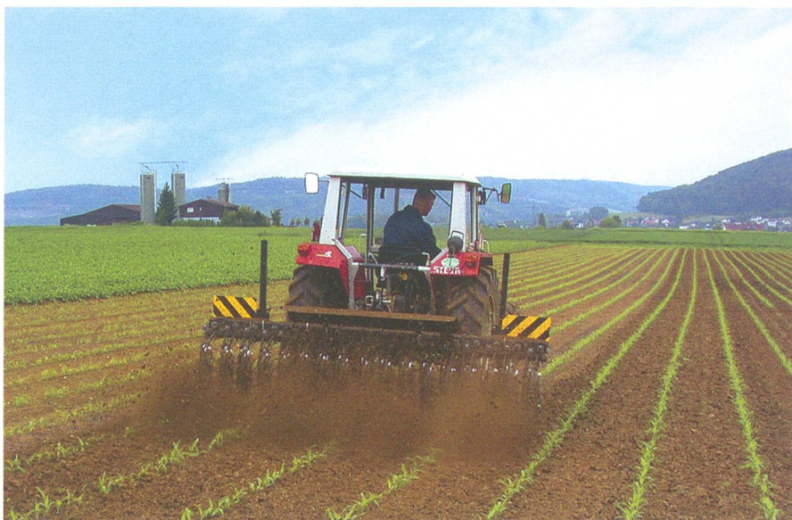
Die amerikanische Rollhacke bricht die Verkrustung an der Bodenoberfläche. Während junge Maispflanzen die Maschine unbeschadet überstehen, sind Zuckerrüben sehr empfindlich.
