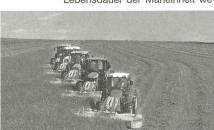
sentlich verlängert. Der Schwerpunkt des Mähers liegt aufgrund der durchdachten Geometrie des Anbaubockes in allen Arbeitspositionen möglichst nahe am Schlepper. Alpha-motion steht für einzigartige Bodenschonung und bildet damit die Basis für eine optimale Futterqualität.
