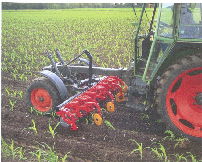
Trennhacke (links) und Fingerhacke (rechts) erfassen das Unkraut auch in der Reihe. Sie sind in der Anschaffung und im Unterhalt relativ teuer
