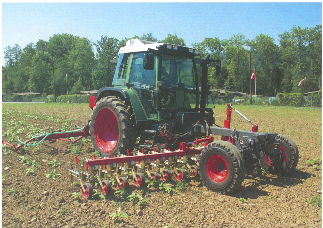
Scharhackgerät vorn, Striegel hinten. Geräte mit 6 oder gar 9 Meter Arbeitsbreite erhöhen die Leistungsfähigkeit..
