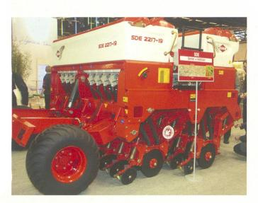
Kompakte, schwere Bauweise: Typisch für jede Direktsaatmaschine. Die Direktsätechnik findet als sehr wirtschaftliche Sämethode zwar regen, als integrales Konzept des Boden schonenden Ackerbaus aber nur zögerlichen Zuspruch. Direktsaatmaschine von Kuhn mit Scheibenscharen, im Gegensatz zu einer Semato, die mit Meisselscharen arbeitet.
