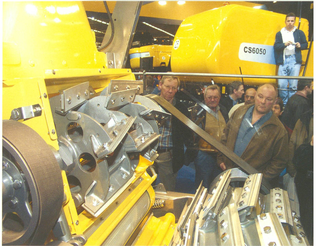
Feldhäcksler NH FR 9000: Minutenschnelle Umrüstung für Mais oder Feuchtgetreide bzw. Grassilage durch das «Variflow-System».
