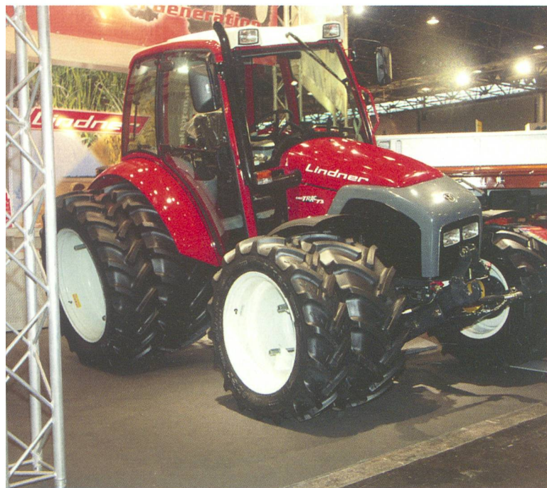
Kecker Lindner Geotrac. Nicht nur die Doppelbereifung, sondern auch die gelenkige Aufhängung der Vorderachse prädestinieren ihn für den Einsatz in Hanglagen.
