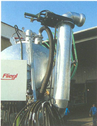
Der neue Saugarm befüllt Güllefässer ohne Absteigen. (Foto: zvg)
