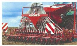
Der Saatguttank ist fest am Dreipunktbock der Kreiselegge aufgebaut. (Foto: zvg)
