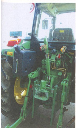
Diesel wird in diesem zusätzlichen Tank mitgeführt. (Quelle: Merk)
