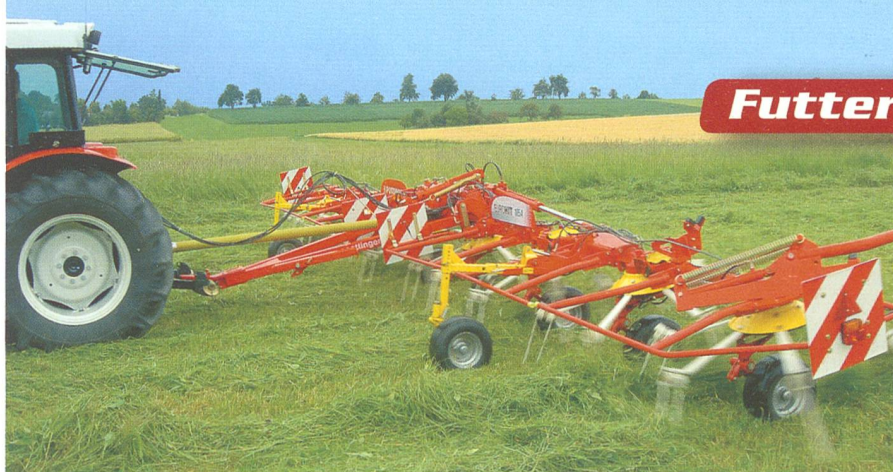
Pöttinger Eurohit 105 mit vorlaufendem Tastrad für eine erhöhte Bodenanpassung (Werksfoto).
