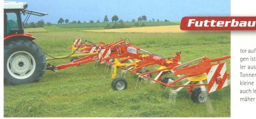
Pöttinger Eurohit 105 mit vorlaufendem Tastrad für eine erhöhte Bodenanpassung (Werksfoto).
