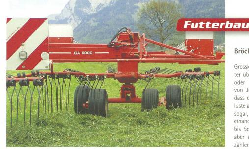
2-Kreisel-Seitenschwader: Bröckelverluste nicht grösser als bei Einkreiselschwadern.
