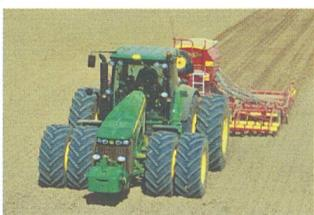
Alle Komponenten für ein automatisches Lenksystem sind bei den JD 8030er-Traktoren vorhanden.
