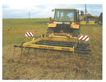
Abbildung 4: Mit einem Strohstriegel können Stroh und Spreu mit wenig Aufwand verteilt werden.
