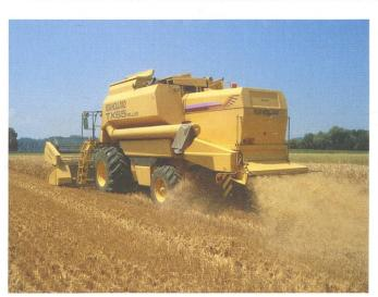
Abbildung 3. Leistungsfähige Häcksler und zusätzliche Spreuverteiler helfen mit, bei der Getreideernte die Pflanzenreste über die gesamte Schnittbreite des Mähdreschers zu verteilen.
