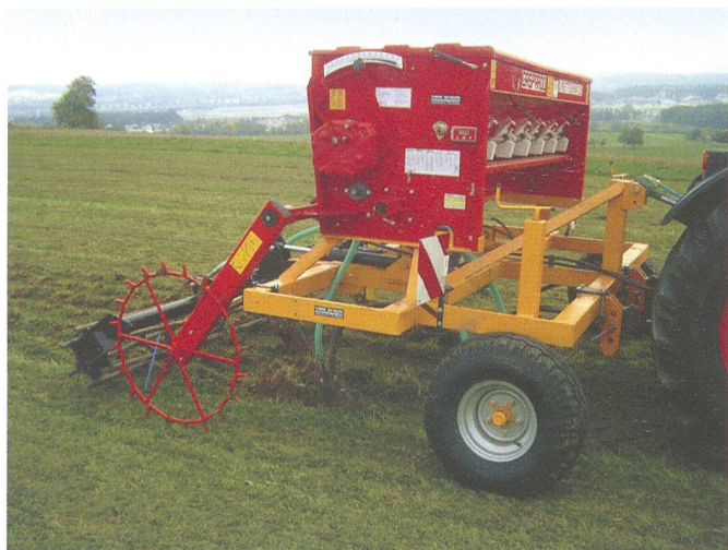
Abbildung 2: Direktsaat von Winterweizen in einen Weissklee-Bestand mit einer Zinkenschar-Sämaschine.
