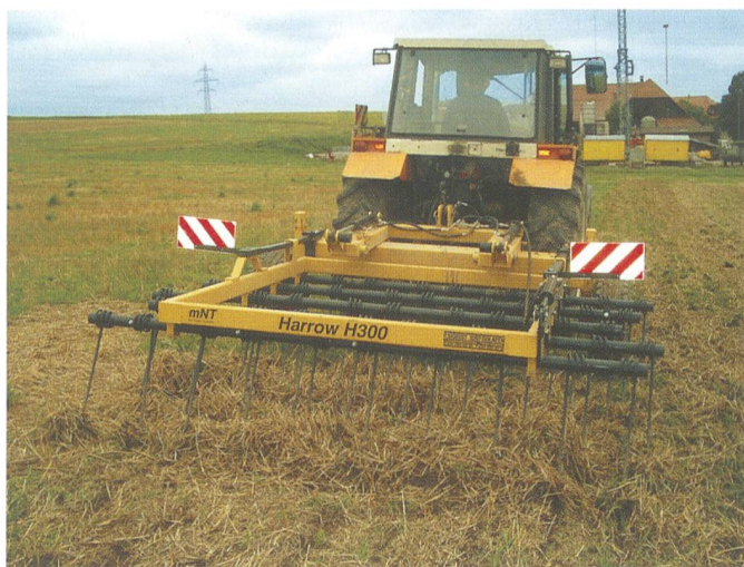
Abbildung 4: Mit einem Strohhriegel können Stroh und Spreu mit wenig Aufwand verteilt werden.
