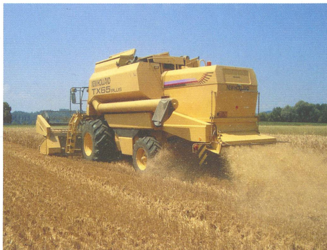
Abbildung 3: Leistungsfähige Häcksler und zusätzliche Spreuverteiler helfen mit, bei der Getreideernte die Pflanzenreste über die gesamte Schnittbreite des Mähdeschers zu verteilen.
