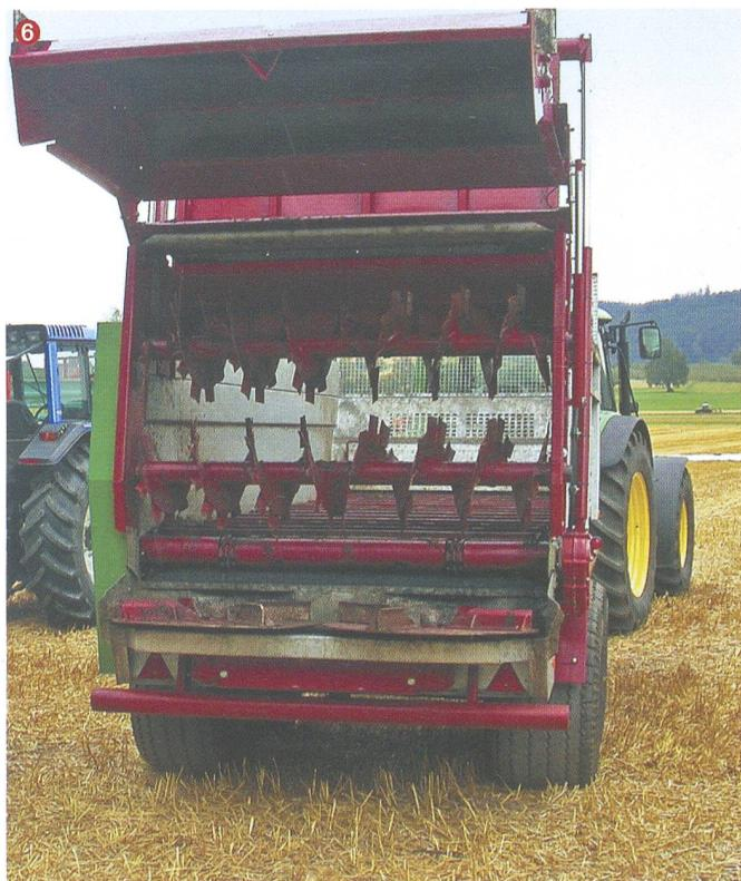
6 Die zwei liegenden Walzen fräsen den Mist oder Kompost ab. Dieser fällt auf die beiden Teller und wird breitgestreut. (Beim Betrieb ist die Heckklappe unten.)
