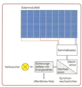
Schema einer Fotovoltaik-Anlage
