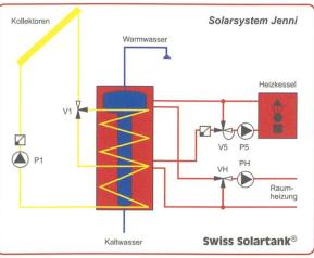
Schema einer Anlage für solare Wärme
