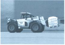
arme mit zuschaltbarer Schwingungsdämpfung erreichen Hubhöhen von 6,10 m oder 7,10 m sowie Hubkräfte von 3,0 bis 4,1 t. So werden die vier Modelle der Scorpion-Serie zu kleinen aber starken Leistungsträgern.
