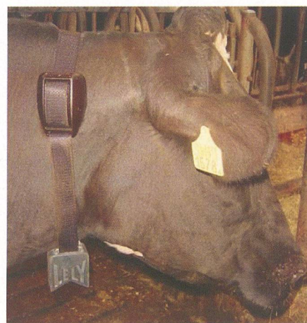
Die Lely «Qwes-HR»-Wiederkau-Aktivitätsmessung mithilfe eines Halsbandmikrofons.
